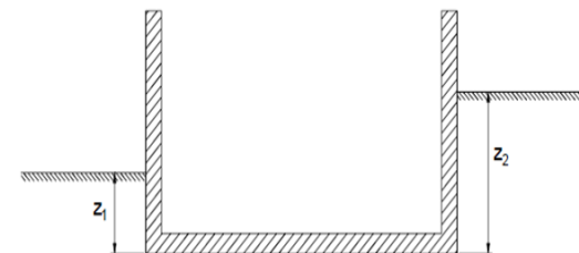
Σχήμα 3.2. Ενδεικτική διατομή κτηρίου για τον προσδιορισμό του το βάθους έδρασης πλάκας επί εδάφους με διαφορετικές στάθμες έδρασης λόγω κεκλιμένου εδάφους.
